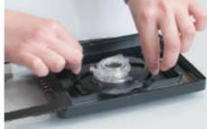
采用弹性阻尼设计，万一物镜和培养皿底部干扰，可防止培养皿和物镜的损坏。
